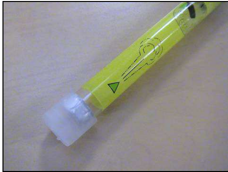
Soufflage direct dans le tube contenant le réactif
