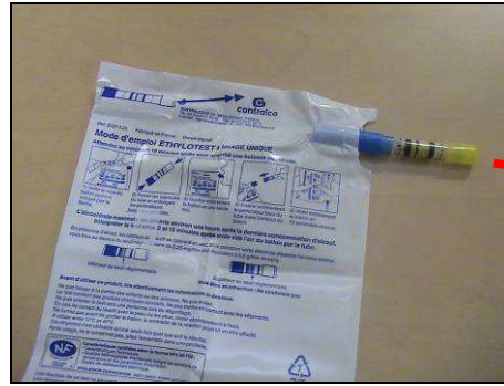
Soufflage dans le ballon, puis vidage du ballon vers l'extérieur à travers le tube
